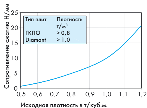
Сопротивление сжатию гипсокартонных плит в зависимости от исходной плотности
